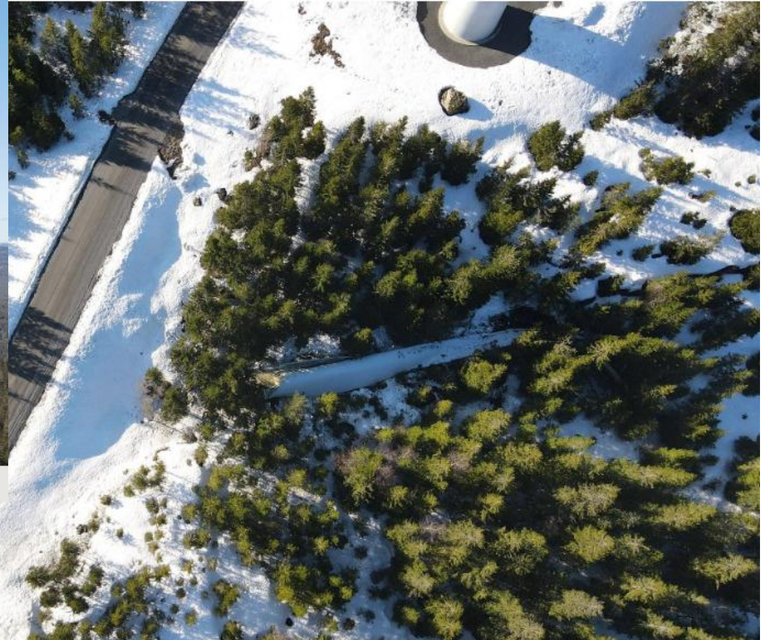
DRAMATISK: Vingebladet ble slynget 50 meter fra vindturbinen. Foto: Odal vindkraftverk
